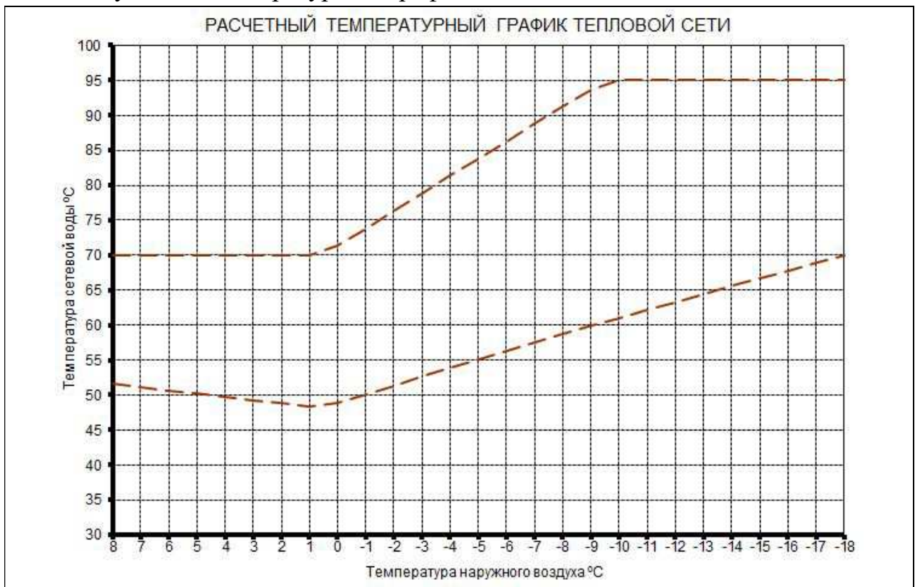
Рисунок 5. Температурный график 115 - 70 °С для отопления с ГВС
